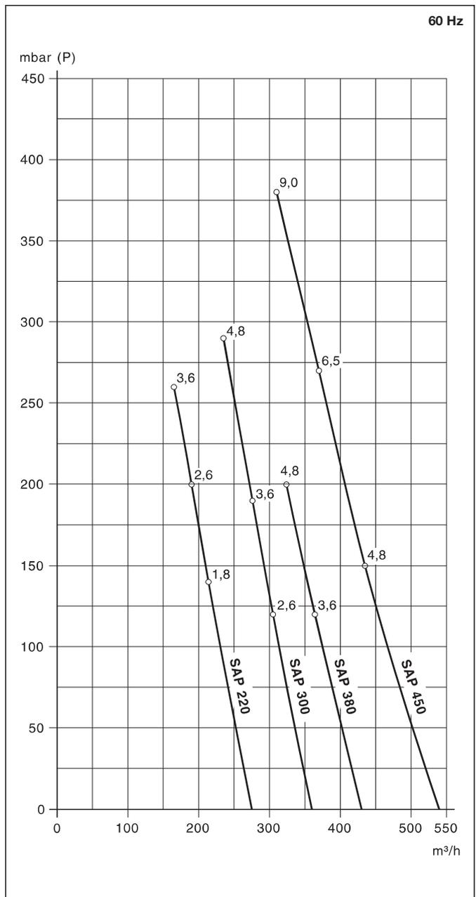
Die Kennlinien haben eine Toleranz von ±10% und beziehen sich auf freie atmosphärische Luft von 1 bar (abs.) und 20°C./ The curves have a tolerance of ±10% and refer to free atmospheric air at 1 bar (abs.) and 20°C./ Les courbes ont une tolérance de ±10% et sont établies à l'atmosphère de 1 bar (abs.) à 20°C./ Le curve hanno una tolleranza del ±10% e si riferiscono alla pressione atmosferica di 1 bar (ass.) e 20°C.
