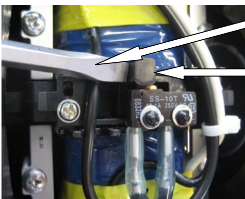
Bild 9: Zurücksetzen des Schutzschalters mithilfe eines Schraubendrehers, der im unteren Bereich der Rückstellkappe ansetzt.
